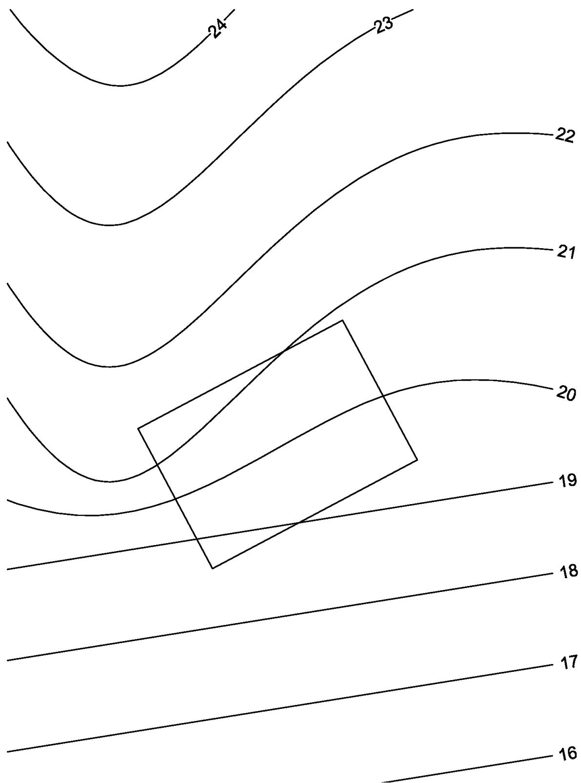
**Příklad č. \_\_ :** Je dána část komunikace. Terén je určený vrstevnicovým plánem. Vyřešte spojení cesty s terénem:  $s_n = 1$ ,  $s_v = 5/3$ , M 1:100.
