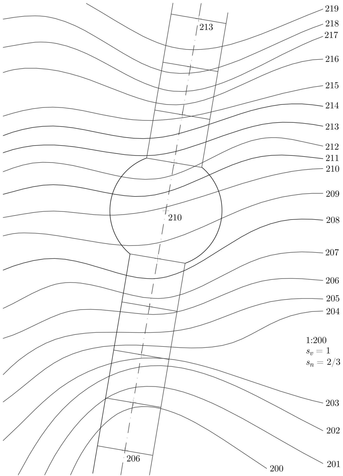
**Příklad č. \_\_:** V daném terénu sestrojte násypy (s<sub>n</sub> = 1) a výkopy (s<sub>v</sub> = 3/2) hřiště v měřítku 1:500.
