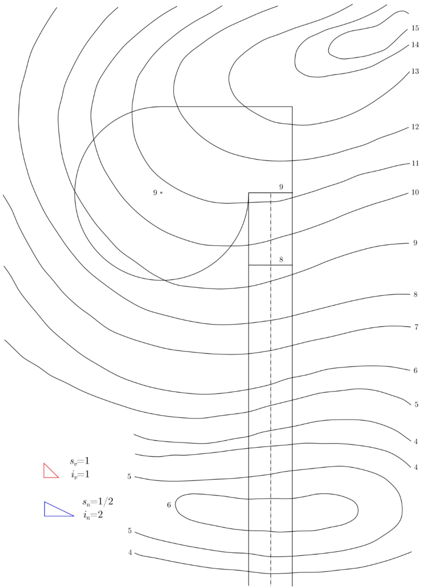
**Příklad č. \_\_ :** Určete spojení daného objektu s okolním terénem pomocí výkopů a násypů. Objekt je tvořen cestou stoupající k plošině, která je ve výšce 9. Spád výkopů  $s_v = 2/3$ , spád násypů  $s_n = 4/5$ . Velikost *ekvidistance* v daném měřítku je dána graficky.
