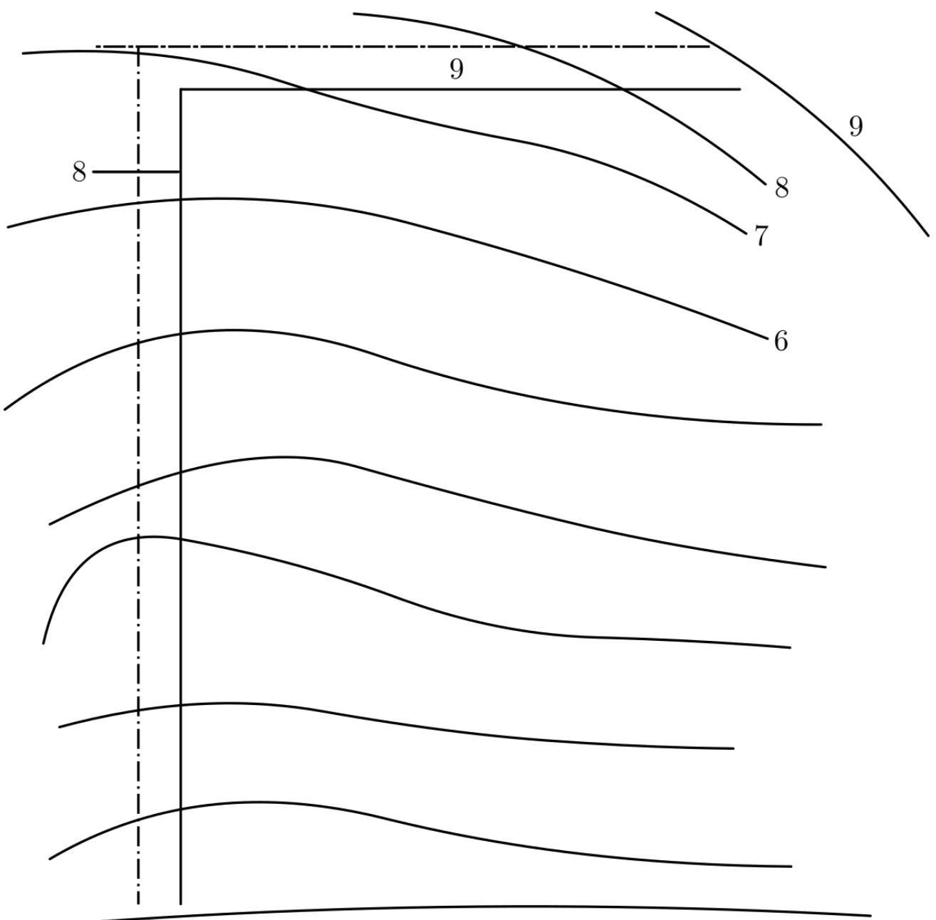
**Příklad č. \_\_:** Do terénu, který je dán vrstevnicovým plánem, umístěte vodorovnou cestu. Násypové roviny volte o spádu 2:3 a výkopové 1:1. Měřítko je 1:200.
