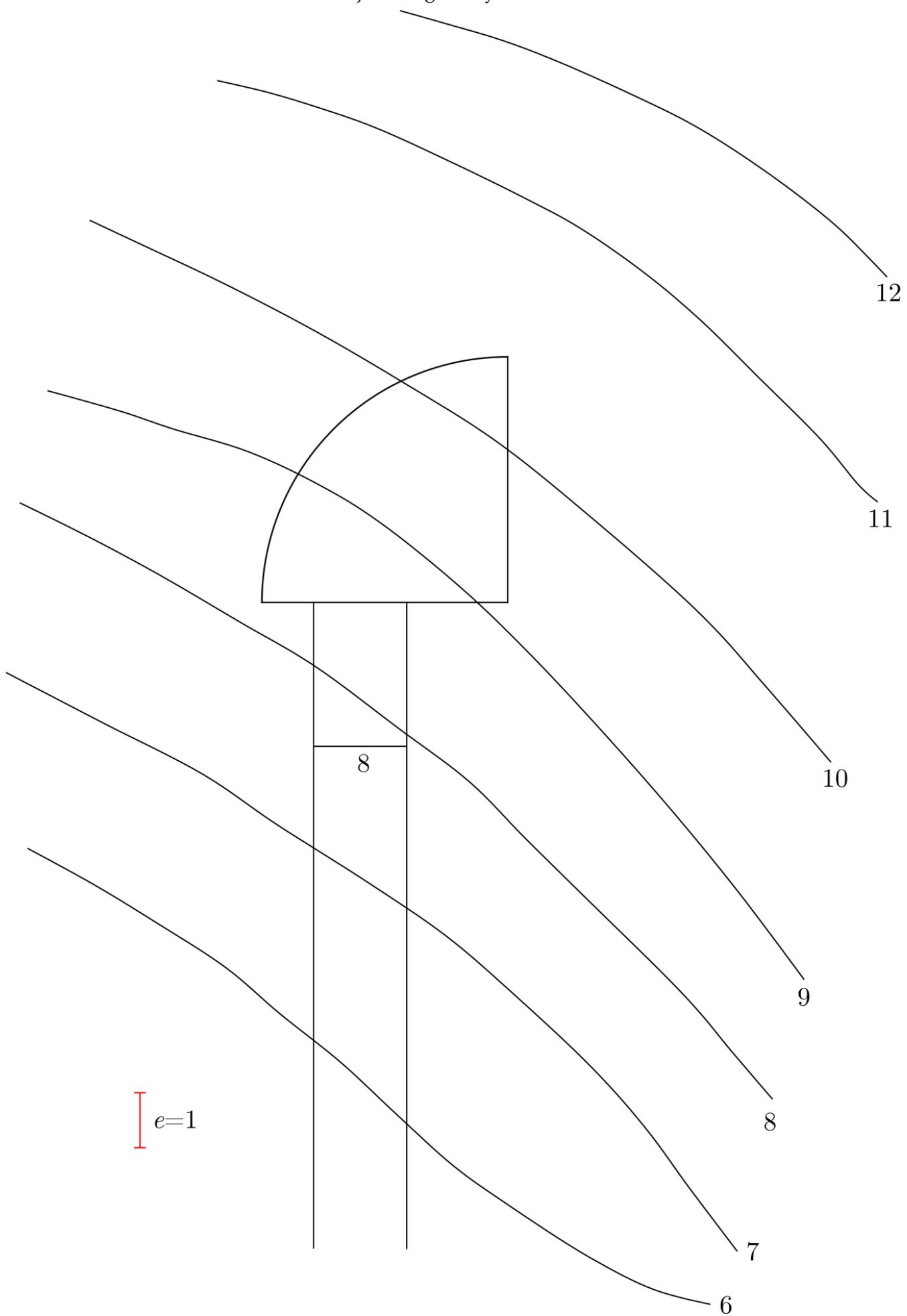
**Příklad č. \_\_:** Určete spojení daného objektu s rovinným terénem pomocí výkopů a násypů. Objekt je tvořen vodorovnou cestou a plošinou ve výšce 5, rovina terénu je dána hlavními přímkami o kótách 6 a 7. Spád výkopů  $s_v = 2/3$ , spád násypů  $s_n = 1$ . Velikost *ekvidistance* v daném měřítku je dána graficky.
