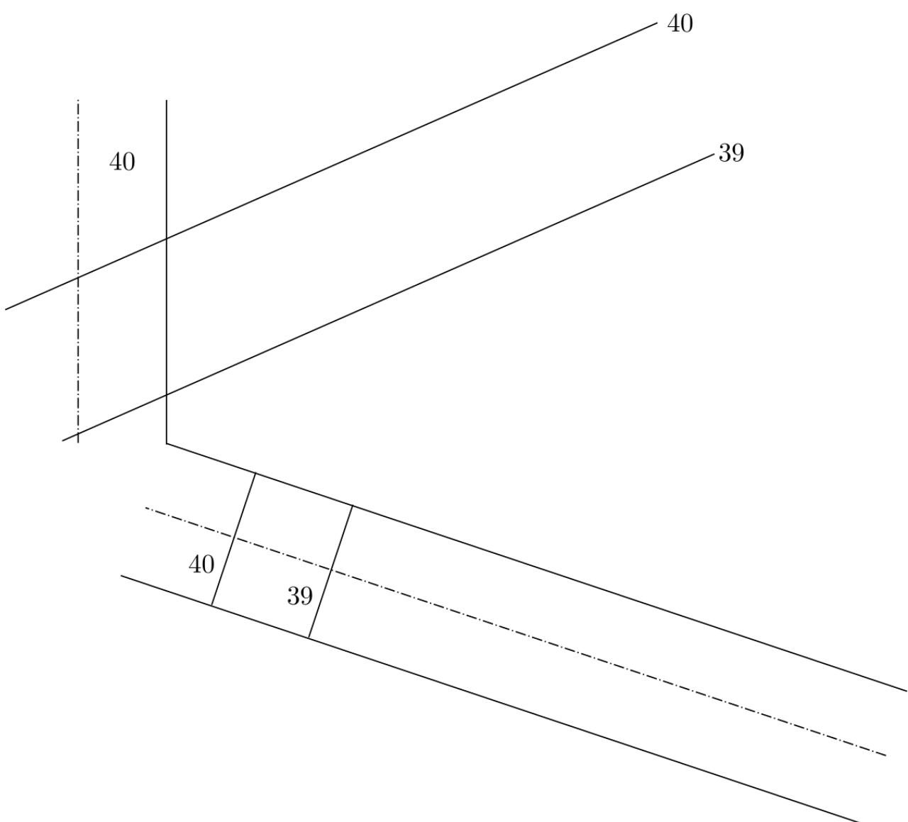
**Příklad č. \_\_ :** Je dána část komunikace. Terén je určený vrstevnicovým plánem. Vyřešte spojení cesty s terénem:  $s_n = 6/7$ ,  $s_v = 1$ , M 1:100.
