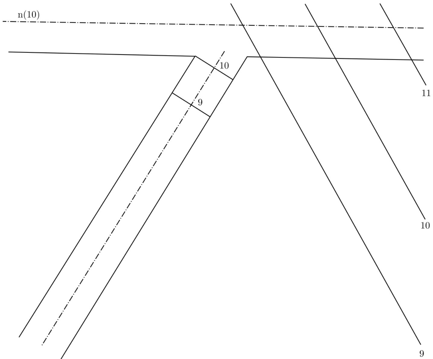
**Příklad č. \_\_ :** Pomocí výkopů a násypů spojte daný objekt (kruhové plošina o kótě 9, navazující cesta) s terénem. Spád výkopů  $s_v = 1$ , spád násypů  $s_n = 1/1$ . Spádové měřítko je dánou graficky.
