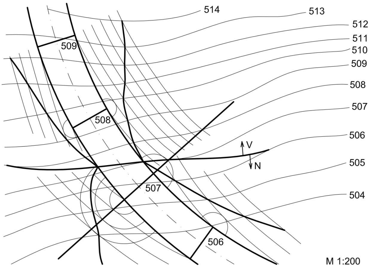
Příklad č. \_\_: Sestrojte průsečíky čáry  $c$  s topografickou plochou.
