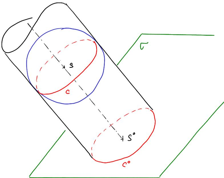
VIZ MP: ZDÁNLIVÝM AXONOMETRICKÝM PRŮMĚTEM KOULE JE KRUŽNICE O POLOMĚRU ROVNÉM POLOMĚRU KULOVÉ PLOCHY A O STŘEDU V AXONOMETRICKÉM PRŮMĚTU STŘEDU KULOVÉ PLOCHY.
