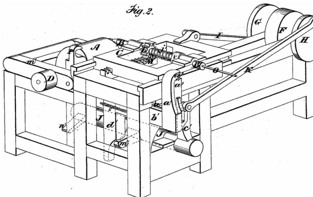
Ukázka axonometrie – dimetrie na výkresu patentu (US Patent – 1874).
