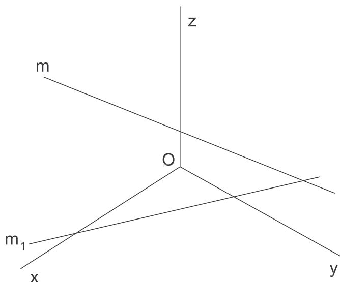
K určení přímky stačí její dva libovolné průměty, zpravidla používáme axonometrický průmět a půdorys.
