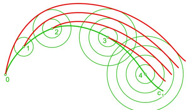
Příklad: Určete spojení stoupající zatáčky s terénem.  $s_n = 1/2$ ,  $s_v = 3/4$ , M 1:200.
